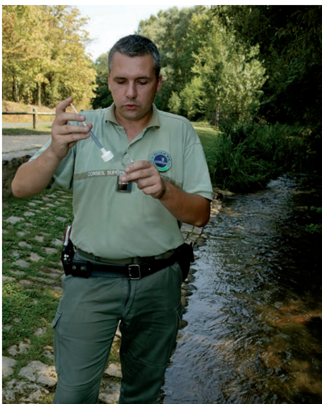
Mesure d'oxygène dissous immédiat (méthode Wincker) par un agent du CSP, Conseil supérieur de la pêche Thierry Degen/MEDDE
